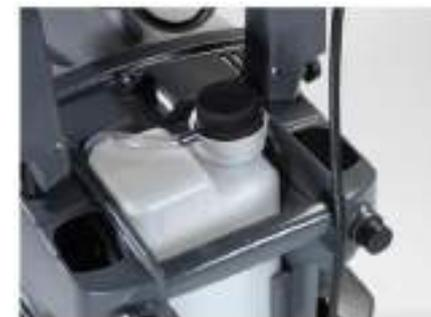
2) С помощью **пенообразующего комплекта**, в этом случае процесс всасывания определяется как всасывание **при низком давлении**, когда моющее средство всасывается во время выхода воды из пистолета (благодаря эффекту Вентури) через приспособление, состоящее из небольшого резервуара, в котором вода смешивается с моющим средством, прежде чем выйти наружу.
